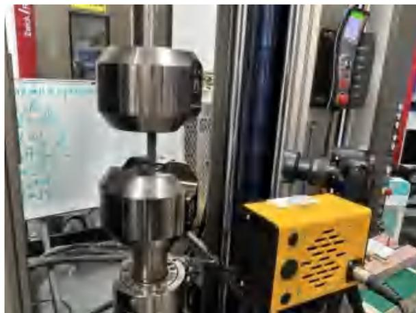
图 3 胶接强度测试示意图
