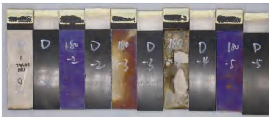
图 13 打磨处理的钛合金单搭接试验件拉剪破坏后胶接界面形貌
