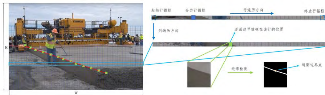
图 5 基于行锚框的道面边界检测算法示意图
