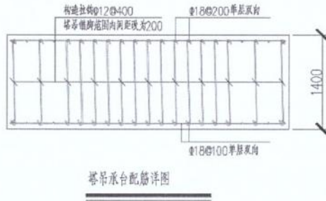
优化方案裙房塔吊基础示意图
