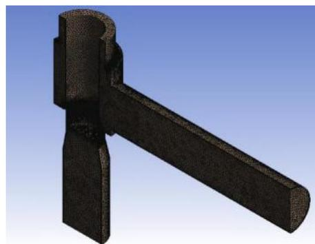
图 1 经过局部加密的调节阀网格模型
